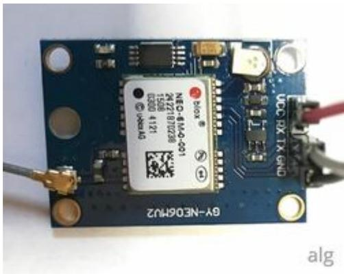
Das NEO-6M GPS Modul funktioniert super. Es kostet in China zwischen 5 und 6 Euro. Es wird mit 3,3v-5 V betrieben .
