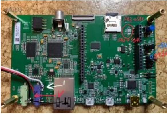
Auf dem Frontend Board muss der weiße rechte Audio Port an den I angeschlossen werden, der linke Audioport, rotes Kabel wird an V angeschlossen . Das schwarze Kabel ist Masse .
