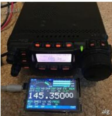
Das ganze ist mehr oder weniger ein Arduino ( die Software läuft auch auf einem Aduino Uno oder Nano mit einem Atmega 328P .
